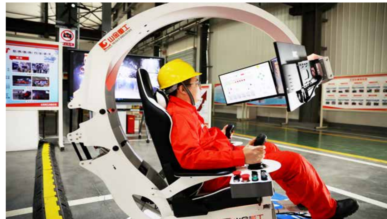
全国首例矿山大型无轨设备基于WiFi6 Mesh组网的远程操控在焦家金矿-寺庄分矿试验成功,实现地表远程操控无轨设备
